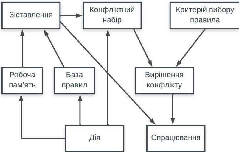
Рис. 6.1. Схема циклу роботи механізму виведення
