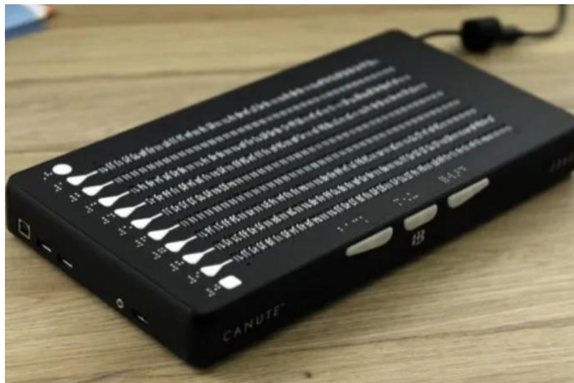
Рис. 2.2.11. Перший і єдиний у світі доступний багаторядковий електронний дисплей Брайля Canute 360.
