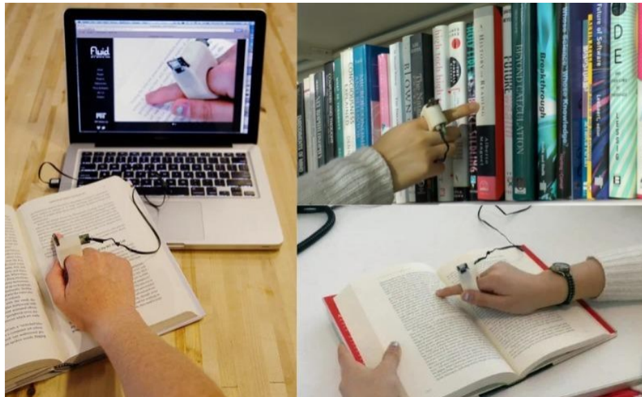
Рис. 2.2.7. Портативний пристрій FingerReader, який озвучує тексти.
