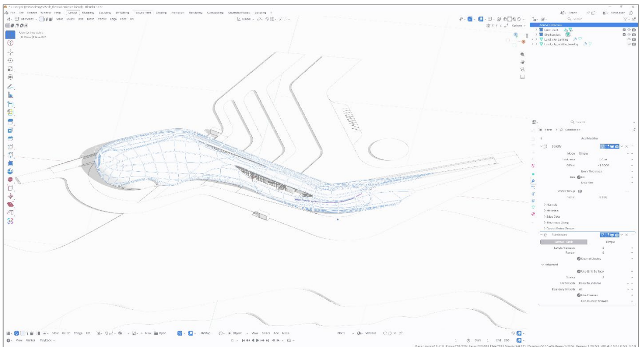
Рис. 3.15. Формування пластичної оболонки об'єкта засобами Subdivision Surface (Blender, ізометричний вигляд)
