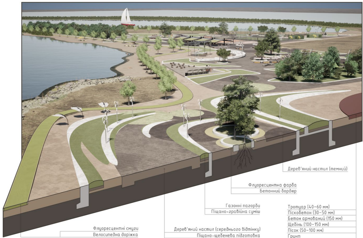
Рис. 3. Схема розрізу паркового дорожнього покриття
