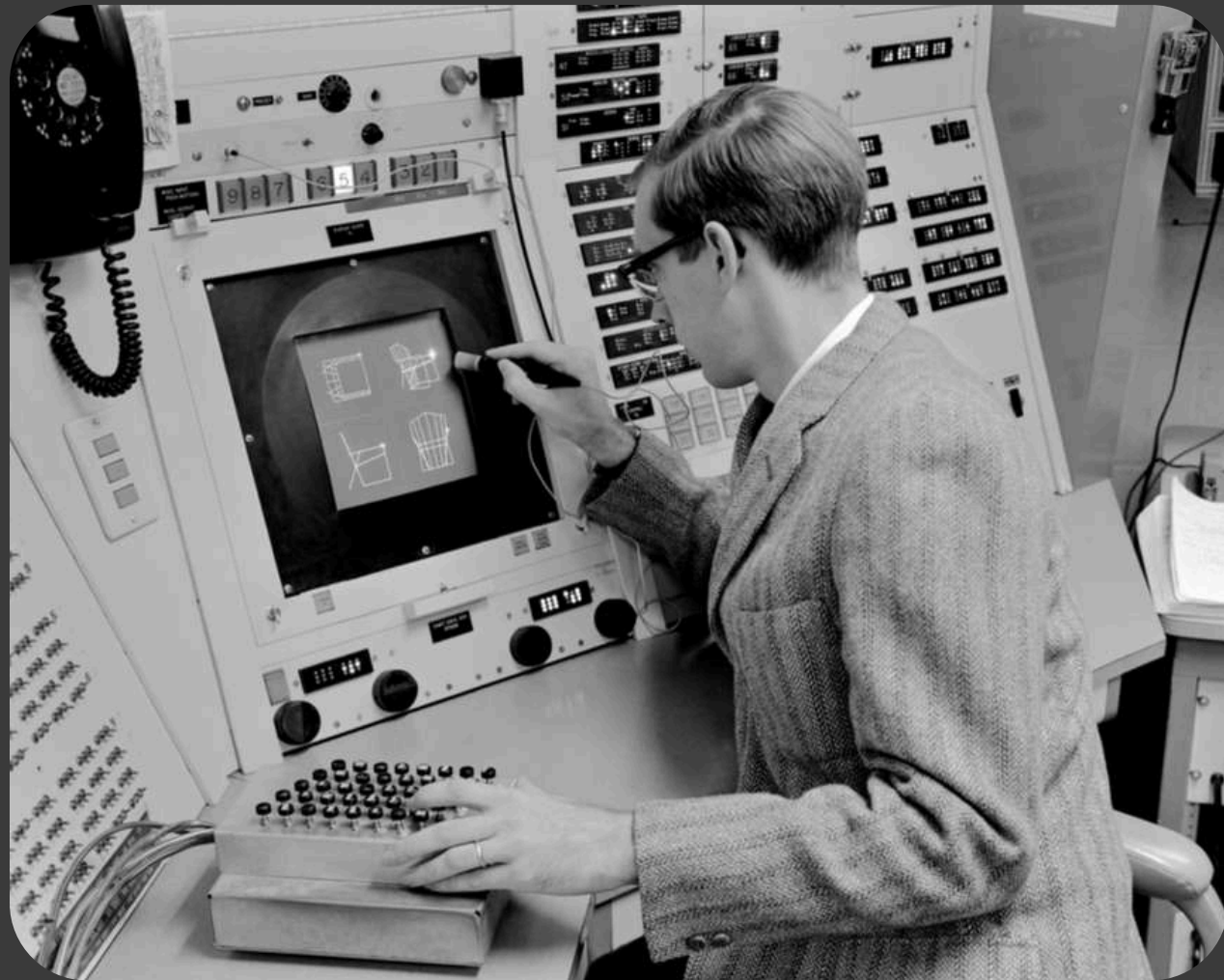
Сазерленд демонструє Sketchpad на TX-2, 1963 рік
