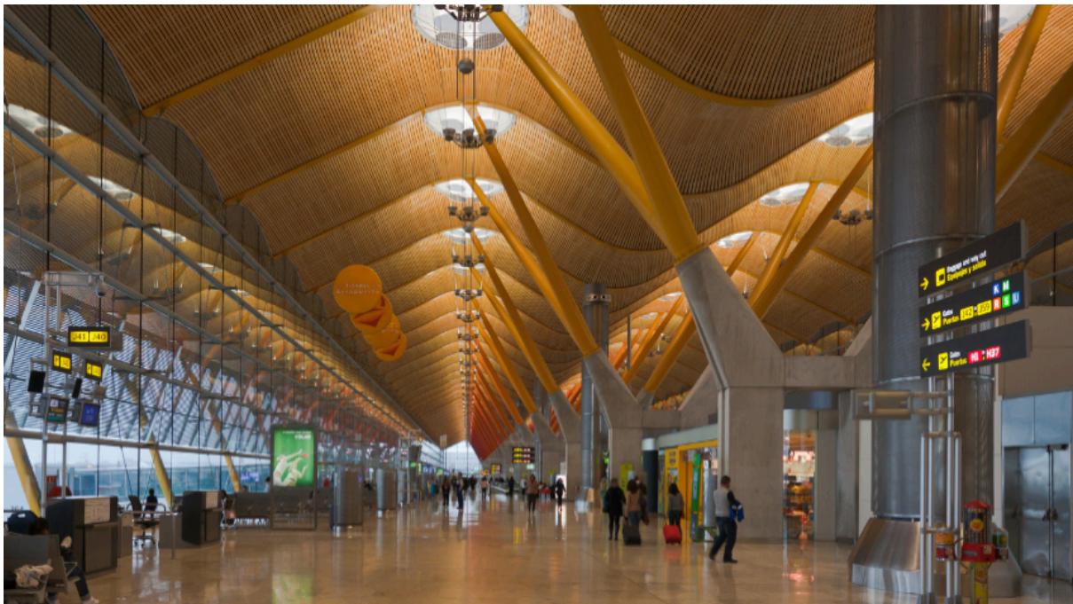
Рис.26: Запровадження природного освітлення згідно з шляхом руху пасажирів від блоку контролю документів до пірсів
