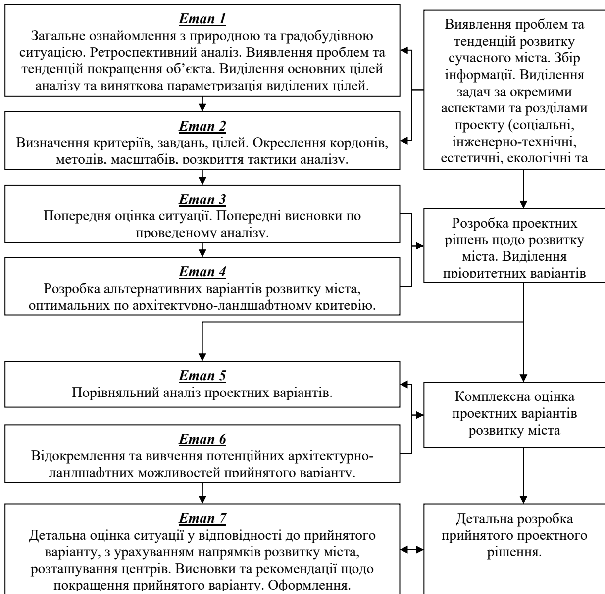
Рисунок 2.6 – Схема реалізації архітектурно-ландшафтного аналізу у процесі здійснення проектування
